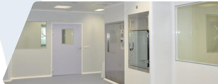
**CUARTOS FRÍOS:** Habitaciones con control de humedad y temperatura con rangos de trabajo de 0 a 4 °C, para el almacenamiento, refrigeración de muestras.
